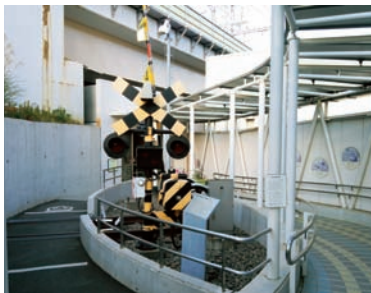
建物外に展示されている踏み切りは、駅に急行が近づくと遮断機が下りる仕組みだ
