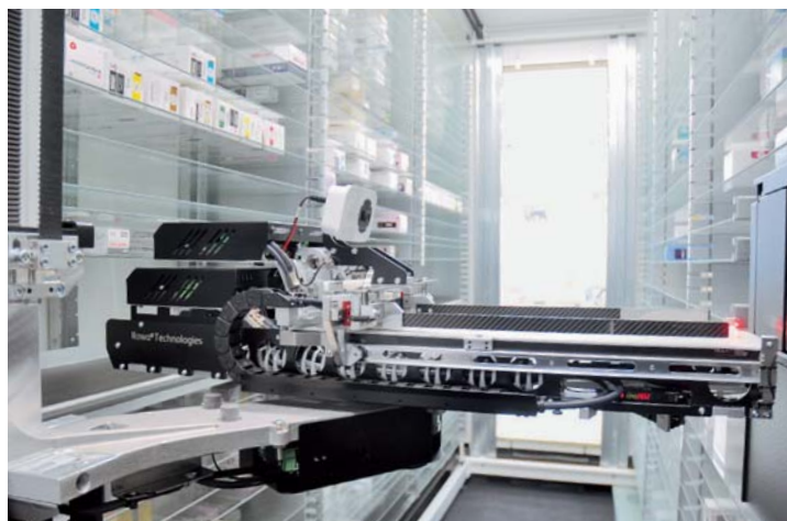
日本DB社製の薬剤の自動ピッキングロボット。処方せんのデータがレセコンに入力されると、アームがスピーディーに動いてロット単位で薬剤をピックアップして払い出す
