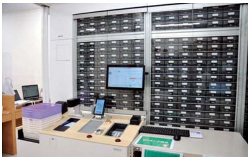
薬剤の自動ピッキング装置。錠剤を箱から出して収納するタイプなので、払い出しの際は装置が錠剤のシートの枚数を数えてピッキングしてくれる
