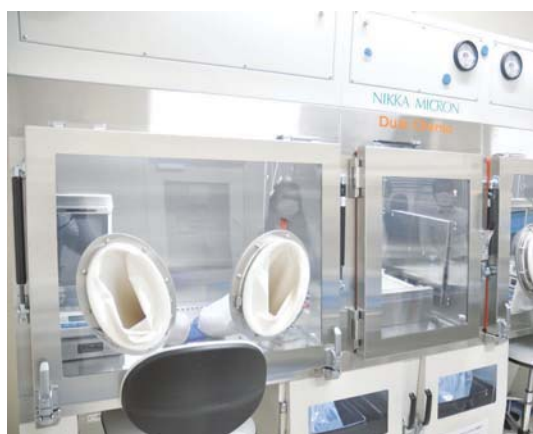
抗がん剤を調製するアイソレーター。内部の残留物は、ダクトを通りフィルターを経て室外排気されるので曝露がない
